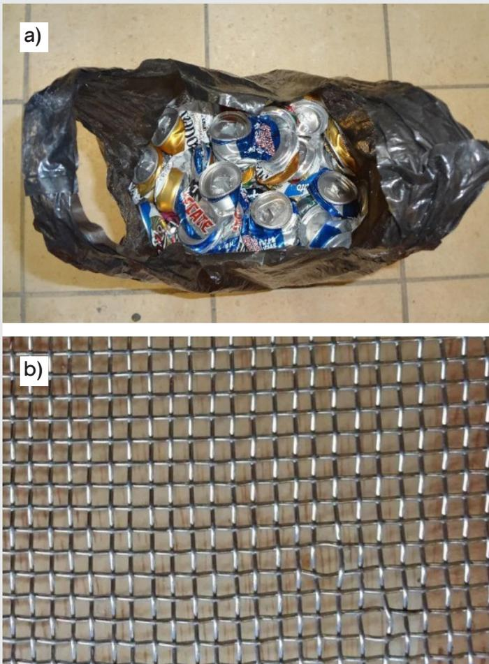
Figura 2: Materiales utilizados a) latas de aluminio b) Malla de acero AISI 304.
